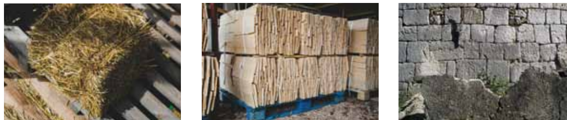
▲ Fig. 71 – Bottes de paille, tavaillons d'épicéa, moellons calcaires sont des matériaux biosourcés et géosourcés.
